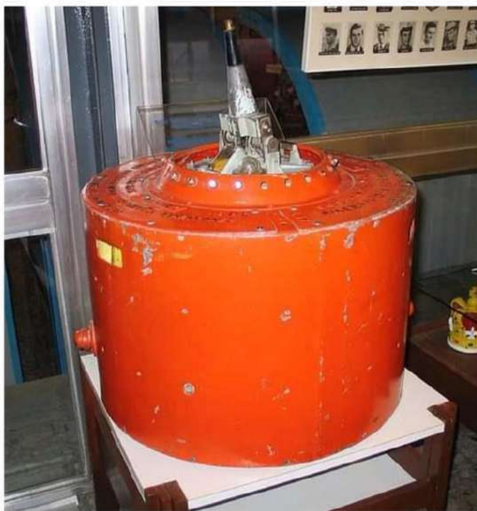
המצוף האחורי של הדקר שנמצא בחוף חאן יונס ומוצג מאז במוזיאון ההעפלה וחיל הים. ניתן להבחין באנטנה שנקצצה בעת הטביעה
